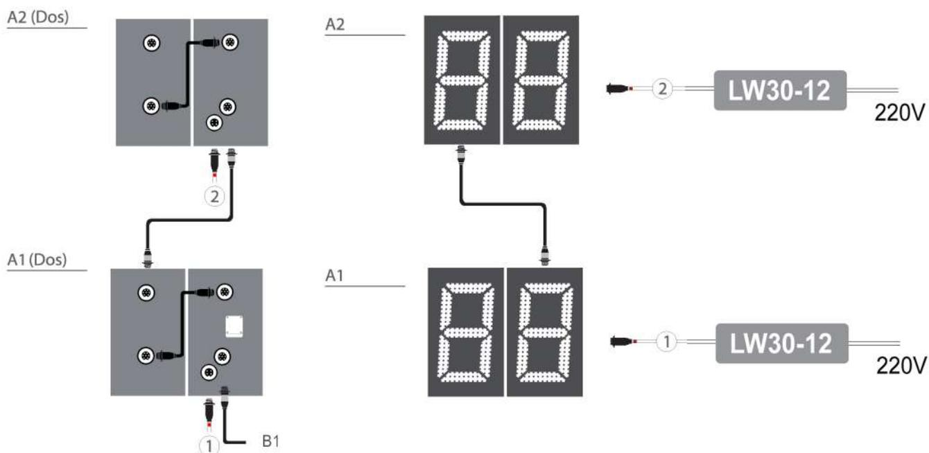
Raccordement : 1 ligne en double face
