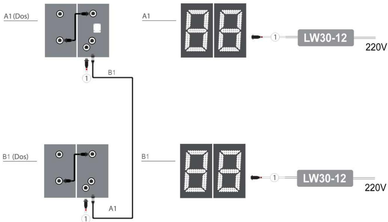
B1 : connexion entre la face A et la face B. Uniquement pour les afficheurs double face
