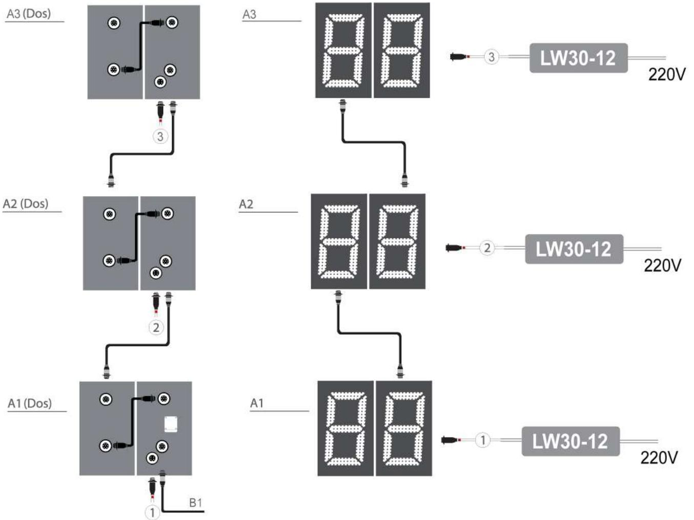
B1 : connexion entre la face A et la face B. Uniquement pour les afficheurs double face
