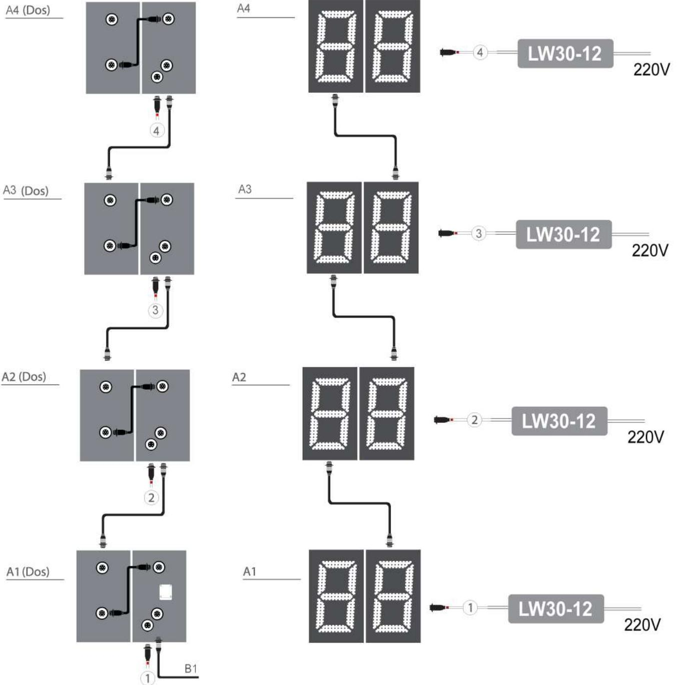
B1 : connexion entre la face A et la face B. Uniquement pour les afficheurs double face
