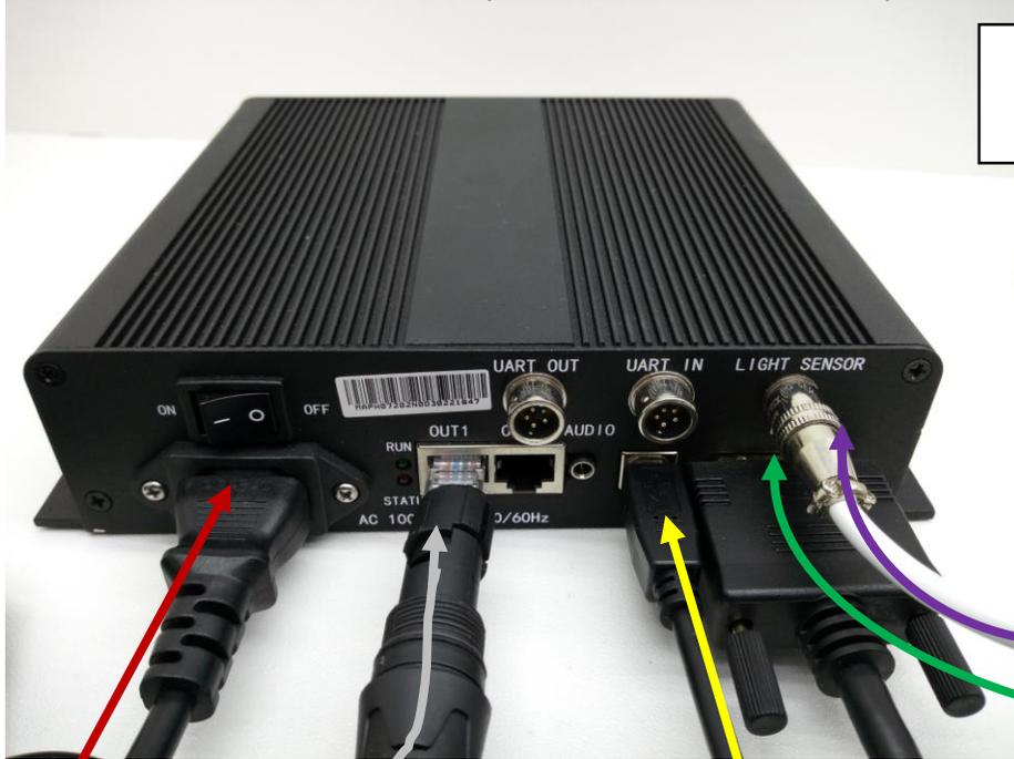
Raccordement de la sonde de luminosité
